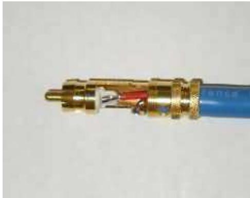
Entfernen Sie die Spannhülse und die Zugentlastungsschraube eines WBT 101+ Cinchsteckers und schrauben Sie diesen auf das Kabel und verlöten Sie ihn wie zuvor beschrieben.
