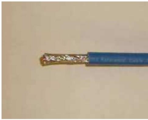
Wechseln Sie zur anderen Seite des Kabels. Isolieren Sie ca. 30mm des blauen Kabelmantels ab.
