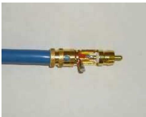
Entfernen Sie die Spannhülse und die Zugentlastungsschraube eines WBT 101+ Cinchsteckers und schrauben Sie den Stecker auf das vorbereitete Kabel.
