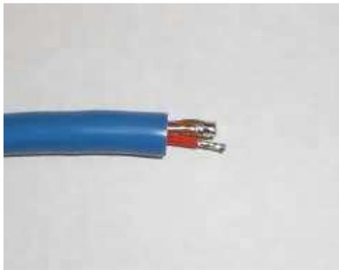
Ziehen Sie den blauen Kabelmantel zum Kabelende bis nur noch etwa 10mm der roten Adern sichtbar sind.
