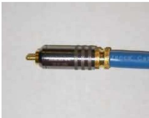
Schrauben Sie die Zugentlastungsschraube in den Stecker und verschließen Sie ihn mit der Spannhülse.
