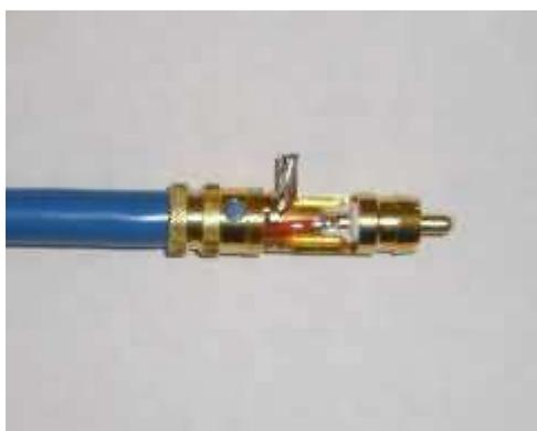
Schrauben Sie den Stecker zurück bis die schwarzen Adern, Abschirmung und Kernstabilisator sich in der linken Ecke befinden.
