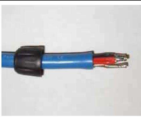
Schneiden Sie die verlöteten schwarzen und roten Adern auf die gleiche Länge wie die verlötete Abschirmung und Kernstabilisator. Demontieren Sie den XLR-Stecker (männlich). Platzieren Sie die Verschraubung des XLR-Steckers auf dem Kabel und ziehen Sie den blauen Kabelmantel in Richtung Kabelende bis nur noch ca. 20mm der Leiter sichtbar sind.
