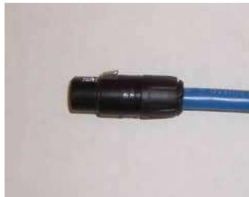
Schließen Sie das Gehäuse der Kupplung.
