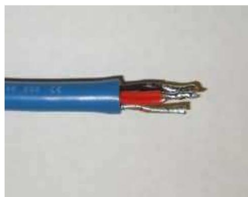
Verdrillen Sie die Abschirmung und den Kernstabilisator (blanker Kupferleiter in der Mitte des Kabels) miteinander.
