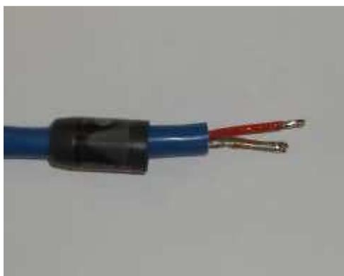
Demontieren Sie den Neutrik Cinchstecker und platzieren Sie das Steckergehäuse auf dem Kabel.
