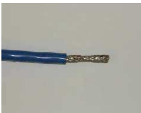
Wechseln Sie zur anderen Seite des Kabels. Isolieren Sie ca. 35mm des blauen Kabelmantels ab.
