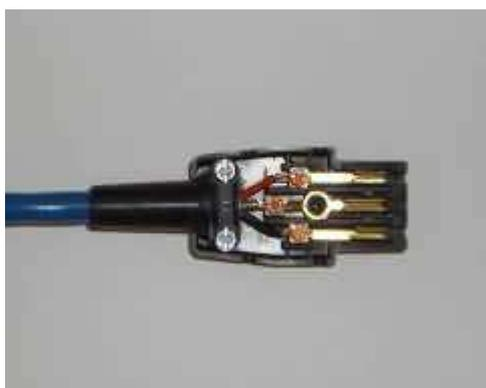
Montieren Sie die Abschirmung auf dem Erdkontakt in der Mitte.
