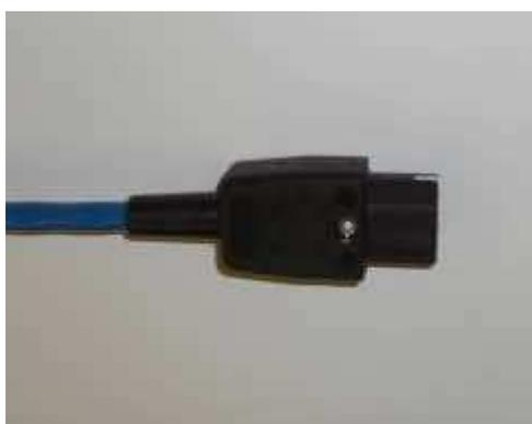
Schließen Sie das Gehäuse der Kaltgerätekupplung.
