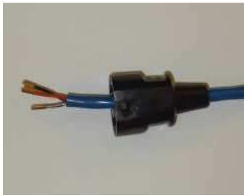
Demontieren Sie den Schukostecker und platzieren Sie das Gehäuse auf dem Kabel.
