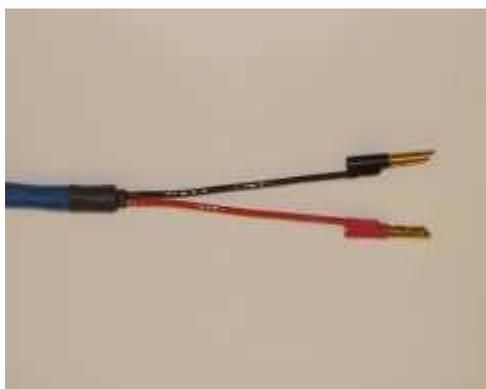
Schieben Sie ein etwa 10mm langes Stück Schrumpfschlauch (9mm auf 3mm – schwarz über die schwarze Ader und rot über die rote Ader) über das verlötete Ende der Bananenstecker (platzieren Sie diese so, dass die verlöteten Enden der Bananenstecker offen bleiben) und schrumpfen Sie dieses.
