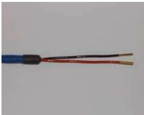
Schieben Sie ein etwa 20mm langes Stück Schrumpfschlauch (9mm auf 3mm – Schwarz für die linke Seite und rot für die rechte Seite) über das Ende des blauen Kabelmantels und schrumpfen Sie dieses.
