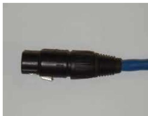
Schließen Sie das Gehäuse der Kupplung.
