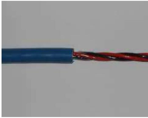
Entfernen Sie einen Teil der transparenten Folie, so dass ein Rest von etwa 10mm am Ende des blauen Kabelmantels übrig bleibt.
