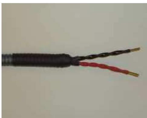
Schieben Sie ein ca. 10cm langes Stück Schrumpfschlauch (18mm auf 6mm – schwarz für das linke Kabel und rot für das rechte Kabel) auf die Enden des TS-Mantels, so dass diese die bereits geschrumpften Aderpaare etwa 10mm verdecken. Schrumpfen Sie diese.
