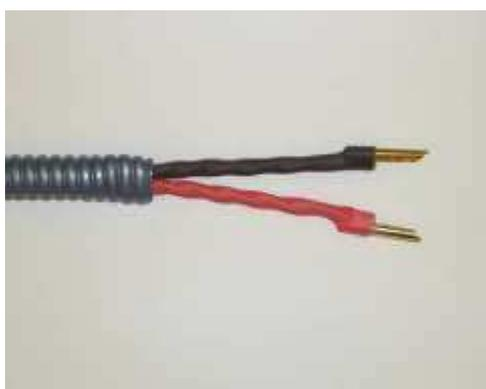
Schieben Sie ein Stück Schrumpfschlauch auf jedes verdrehte Aderpaar (Schwarz auf die schwarzen Adern, rot auf die roten Adern) und schrumpfen Sie diese.
