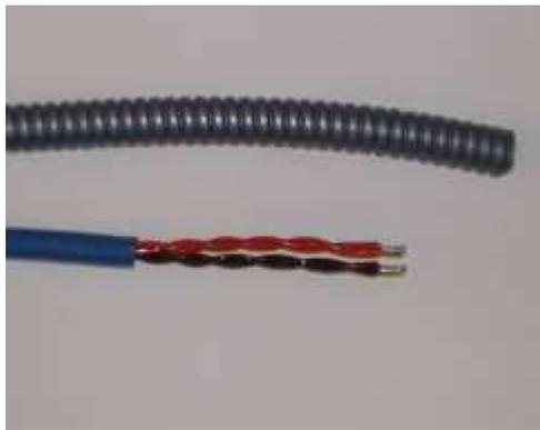
Schneiden Sie ein Stück TS-Premium Mantel (blau-grauer Metallschlauch) auf die benötigte Länge (Länge des Kabels ohne den bereits montierten Stecker plus 5%; bspw. Kabellänge 1m → TS-Mantel 1,05m). Um das abgeschnittene Ende des Mantels wieder zu öffnen, ziehen Sie ein etwa 3-4cm langes Stück des Metallkerns aus dem Mantel und schneiden Sie es ab.
