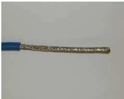
Wechseln Sie zur anderen Seite des Kabels. Isolieren Sie ca. 100mm des blauen Kabelmantels ab.
