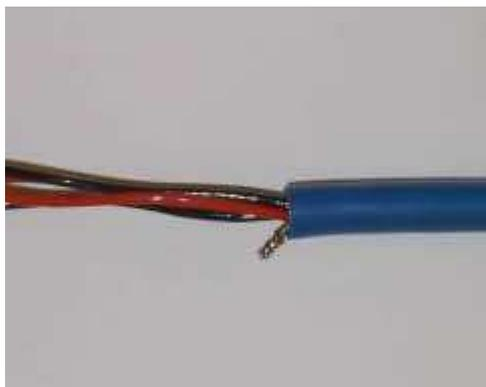
Verlöten Sie Kernstabilisator und Abschirmung und schneiden Sie diese auf eine Länge von 10mm.
