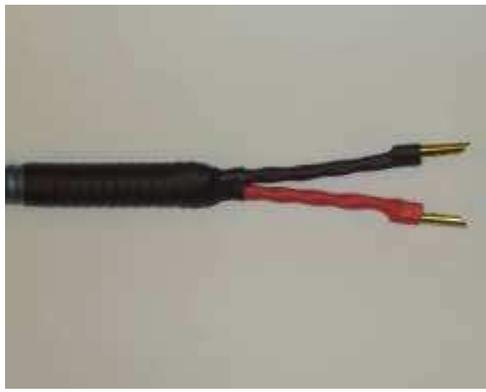
Schieben Sie ein ca. 10cm langes Stück Schrumpfschlauch (18mm auf 6mm – schwarz für das linke Kabel und rot für das rechte Kabel) auf die Enden des TS-Mantels, so dass diese die bereits geschrumpften Aderpaare etwa 10mm verdecken.
