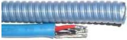
Schneiden Sie ein Stück TS-Premium Mantel (blau-grauer Metallschlauch) auf die benötigte Länge (Länge des Kabels ohne den bereits montierten Stecker plus 5%; bspw. Kabellänge 1m → TS-Mantel 1,05m). Um das abgeschnittene Ende des Mantels wieder zu öffnen, ziehen Sie ein etwa 3-4cm langes Stück des Metallkerns aus dem Mantel und schneiden Sie es ab. Schieben Sie das Kabel in den TS-Mantel.
