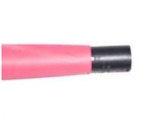
Schieben Sie die Schrumpfschlauchstücke so auf den TS-Mantel, dass diese die Verschraubung des XLR-Steckers/der XLR-Kupplung verdecken. Schrumpfen Sie den Schrumpfschlauch mit einem Heißluftgerät.
