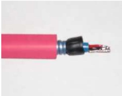
Platzieren Sie zwei ca. 10cm lange Stücke Schrumpfschlauch (18mm : 6mm) über dem TS-Mantel (rot für die rechte Seite – schwarz für die linke Seite). Demontieren Sie den XLR-Stecker (männlich). Platzieren Sie die Verschraubung des XLR-Steckers auf dem Kabel und ziehen Sie den blauen Kabelmantel in Richtung Kabelende bis nur noch ca. 20mm der Leiter sichtbar sind.
